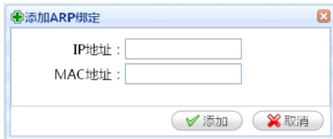
IP 地址：该项显示被绑定计算机的 IP 地址。
